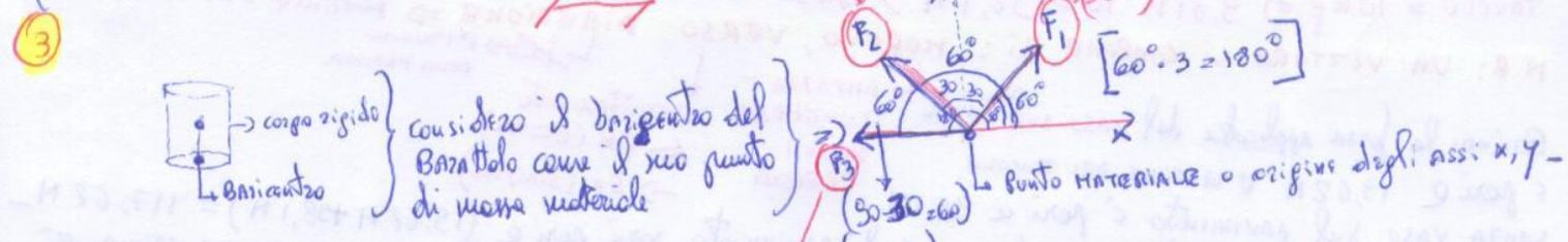
Ricordando che la risultante di due forze concordi  $R = F_1 + F_2$ , mentre la risultante di due forze discordi  $R = F_1 - F_2$  ⇒ le regole del parallelogramma, per cui:
